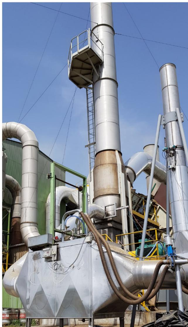
*Le recyclage des particules pour diminuer les émissions de poussières est le chantier essentiel de la fin des années 2010. Ici un pilote testé par L-RD.*
